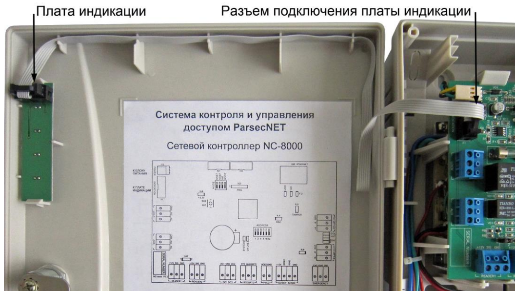
Рисунок 25. Подключение платы внешней индикации
