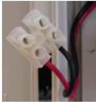
Рисунок 10. Кабель для подключения замка к блоку питания
