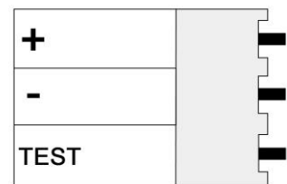
Рисунок 3. Назначение контактов разъема POWER
